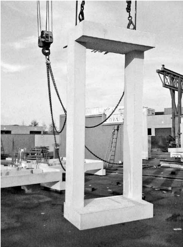
élément de façade chez Verheyen Betonproducten prêt à être transporté
